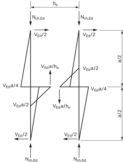
Bild 6.11. Stabkräfte im Endfeld von Stützen mit Bindeblechen
