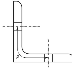
Bild 6.2. Winkel mit Löchern in beiden Schenkeln
