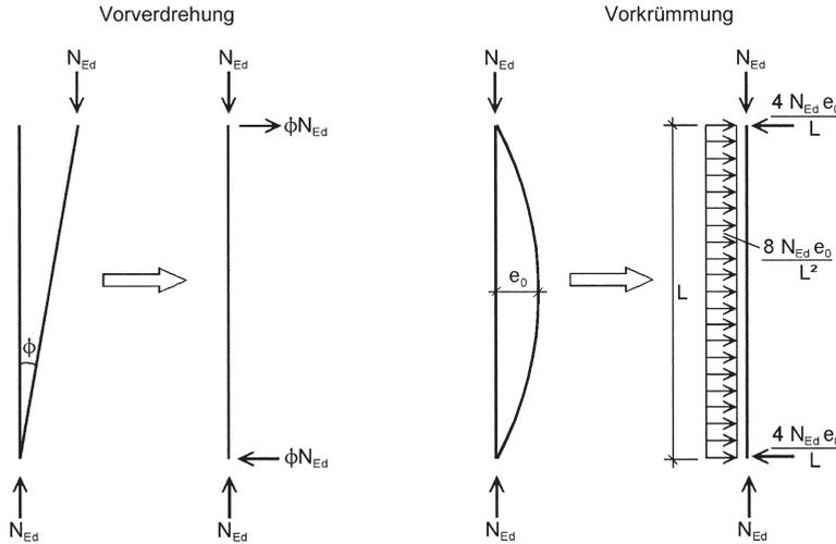
**Bild 5.4.** Ersatz der Vorverformungen durch äquivalente horizontale Ersatzlasten
