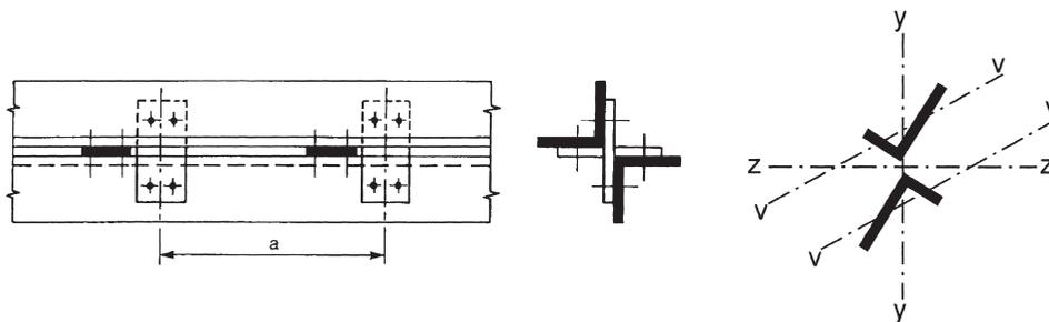
Bild 6.13. Mehrteilige Bauteile aus übereck gestellten Winkeln
