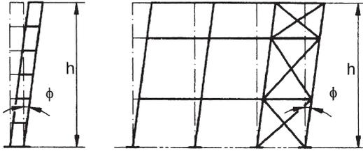
Bild 5.2. Äquivalente Stützenschiefstellung
