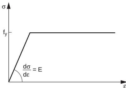
Bild 5.8. Bi-lineare Spannungs-Dehnungsbeziehung
