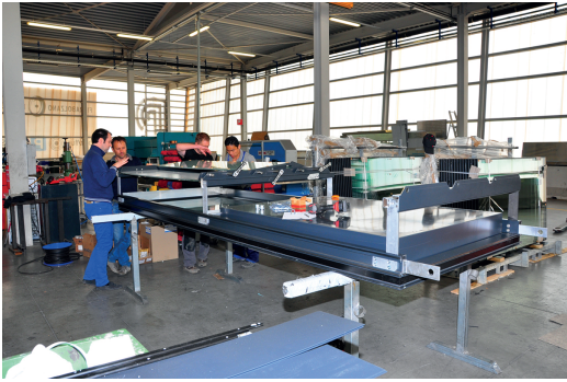
Bild 6. Modulmontage (Quelle: Schüco)
