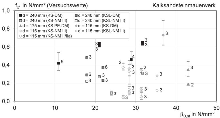
**Bild 8.** Biegezugfestigkeit senkrecht zu den Lagerfugen von Kalksandsteinmauerwerk mit Normalmauer- und Dünnbettmörtel in Abhängigkeit von der Steindruckfestigkeit, Mittelwerte und Streubereich der Einzelwerte, Prüfkörperanzahl [36]
