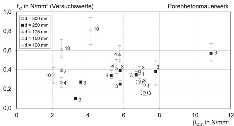
**Bild 9.** Biegezugfestigkeit senkrecht zu den Lagerfugen von Porenbetonmauerwerk mit Dünnbettmörtel in Abhängigkeit von der Steindruckfestigkeit, Mittelwerte und Streubereich der Einzelwerte, Prüfkörperanzahl [16]
