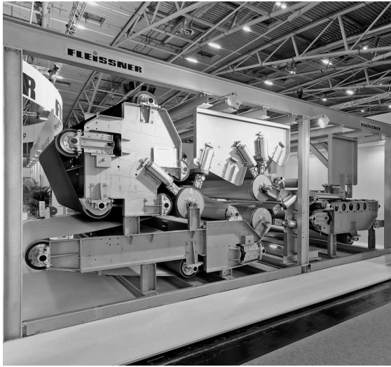
Abb. 6.92 Fleissner-AquaJet mit Trommel-Band-Kompaktierung, 5-stufig, Vliesbreite 3,6 m, eingesetzt für Vliese bis 800 g/m 2
