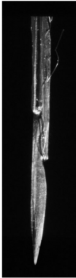
Abb. 6.46 Fasertransport durch Nadelkerbe (mit freundlicher Genehmigung der Fa. Groz-Beckert KG)
