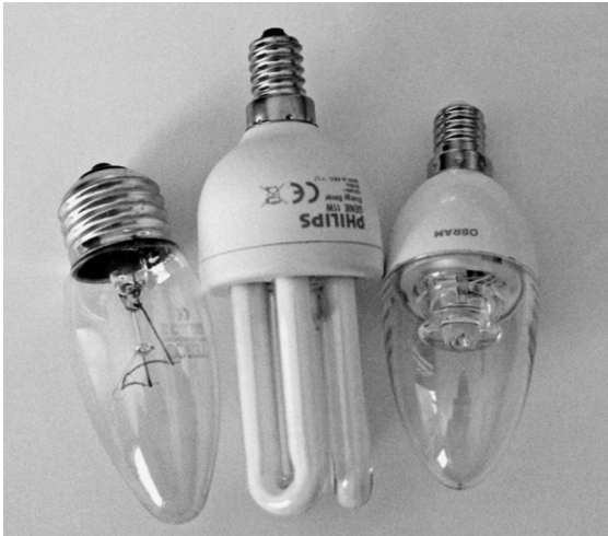
Abb. 1.7 Entwicklungsstufen der Beleuchtungstechnik von der Glühlampe durch die Entladungslampen bis zu den LED-Lampen. Farbbild online.
