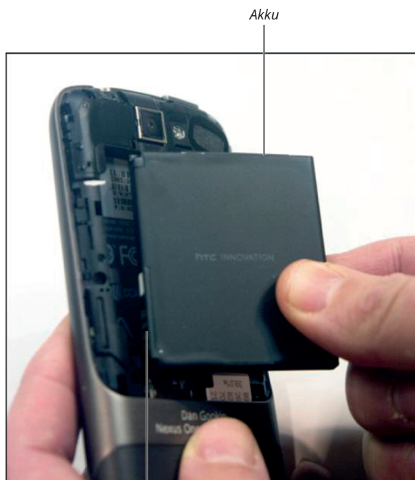
Abbildung 1.1: Den Akku einsetzen
