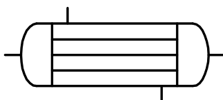
Rohrbündel- Wärmeaustauscher
