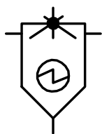
Elektrostatischer Abscheider, nass arbeitend
