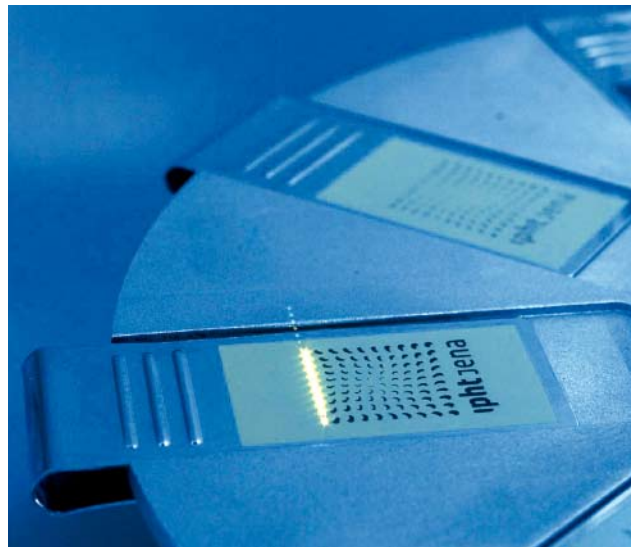
ABB. 5: Laboraufbau für Beschriftungssystem mit Faserlaser (links) Mikrobeschriftung von Federstahl (rechts).
