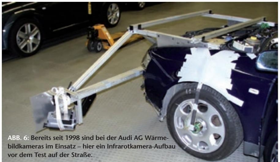
ABB. 6: Bereits seit 1998 sind bei der Audi AG Wärmebildkameras im Einsatz – hier ein Infrarotkamera-Aufbau vor dem Test auf der Straße.
