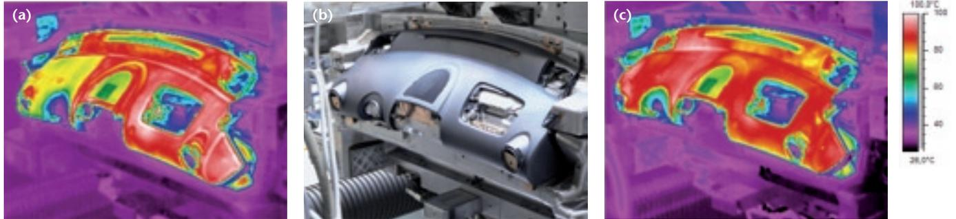
ABB. 4: Industrielle Infrarotkameras eignen sich auch, um Spritzguss-Prozesse zu optimieren. (a) Formteil mit zu geringer Temperatur und dadurch unzureichendem Druckverhalten „zu kurz“, (b) Realbild/Tageslichtbild und (c) Formteil nach thermischer Optimierung Formteillänge „im Toleranzbereich“.
