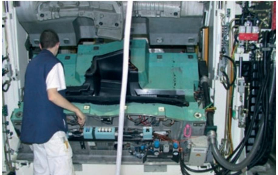
ABB. 1: Schäumwerkzeug für die Produktion von Instrumententafeln im Auto. Bei der Produktion können im Schaum größere oder kleinere Gaseinschlüsse auftreten.
