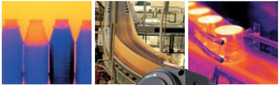
ABB. 5: Plug & Play: Mit der Infrarotkamera für Festinstallationen Thermo-Vision A320 von FLIR Systems lassen sich thermodynamische Prozesse effizient beobachten und Kühlungszyklen von Teilen und Komponenten optimieren.
