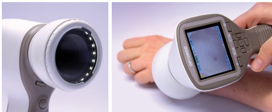
ABB. 1: Digitale Multifunktionskamera mit ringförmigen LED-Lichtquellen.
