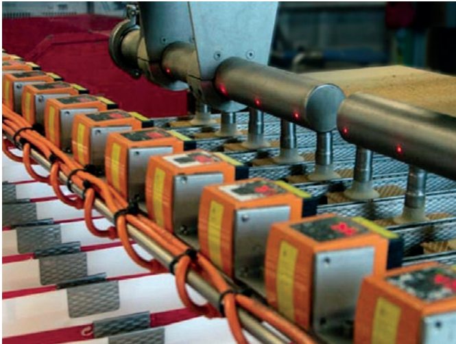
ABB. 3: Der efector pmd in der Eisproduktion (links) und bei der Ausrichtung von Gepäckstücken (rechts, mit freundlicher Genehmigung der ifm electronic gmbh).
