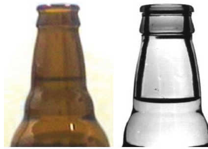
ABB. 13: Prüfung des Füllstands einer Flasche bei Verwendung einer Haushalts-Beleuchtung (links) und einer starken Durchlicht-Beleuchtung (rechts).
