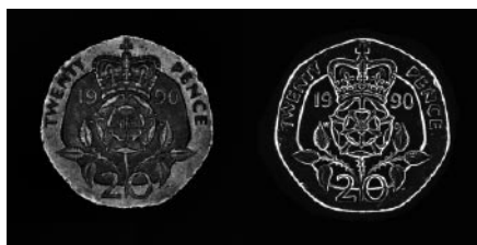
ABB. 3: Darstellung einer Münze mit Hellfeld- (links) und Dunkelfeldbeleuchtung.
