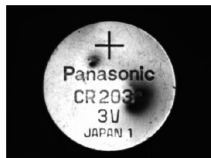
ABB. 10: Das Bild zeigt eine Batterie mit flachen Dellen, beleuchtet mit einer Standard-Koaxial-Beleuchtung (links) und einer kollimierten Beleuchtung (rechts).
