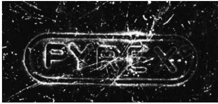
ABB. 15: Mit Hilfe einer Dunkelfeld-Hintergrund-Beleuchtung sind alle Merkmale und Kratzer dieser Glasschüssel klar erkennbar.
