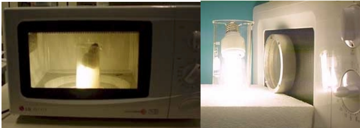
Abb. 4 Leuchtende Entladungslampe in einer laufenden Mikrowelle, rechts vor einem präparierten Gerät.
