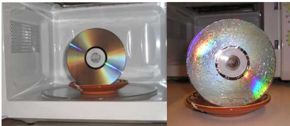
Abb. 6 Eine CD nach dem Erhitzen in der Mikrowelle.
