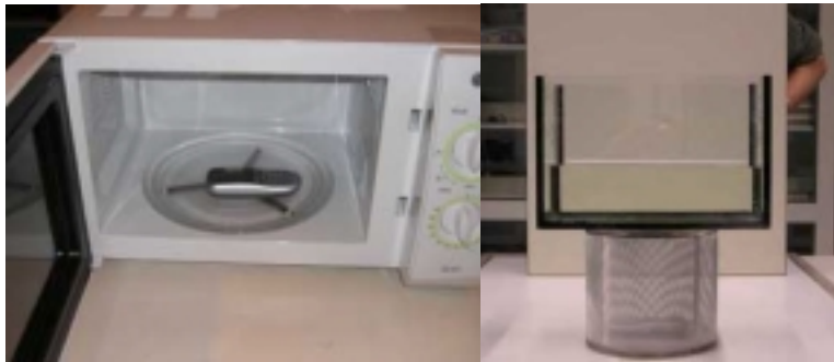
Abb. 2 Handy a) in der Mikrowelle und b) in einem Faradayschen Käfig mit Aquarium als Abdeckung.
