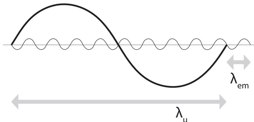
Abbildung 1: Das Bild zeigt eine Undulation eines Elektrons sowie die Strahlung, die es zu Beginn ausgesandt hat. Wenn das Elektron in Längsrichtung um genau eine Wellenlänge  $\lambda_{em}$  zurückgefallen ist, so sind Elektronen und Strahlung nach einer Undulation wieder in Phase.
