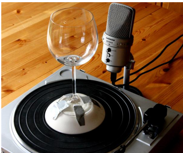
Abb. 3 Ein drehendes Weinglas als Drehratensensor. Der experimentelle Nachweis ist direkt im Spektrum zu erkennen und ist selbst in dieser einfachen Anordnung fast quantitativ.
