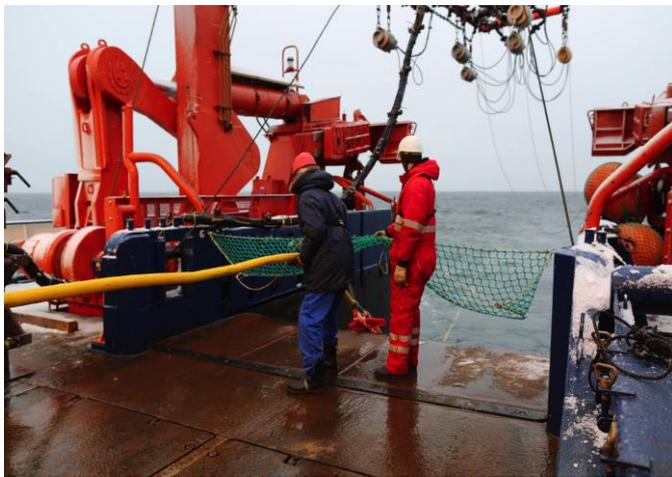
**Abb. 2** Das Messkabel (gelb im Vordergrund) wird zu Wasser gelassen. An dem Gerüst oben hängen die Luftkanonen als seismischen Quellen.
