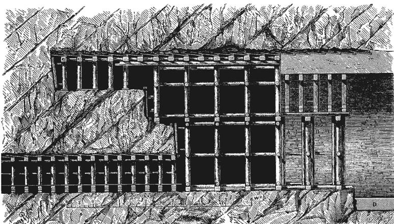
**Bild 1-5** Oesterreichische Bauweise nach Rziha (Längsschnitt) [1-1]
