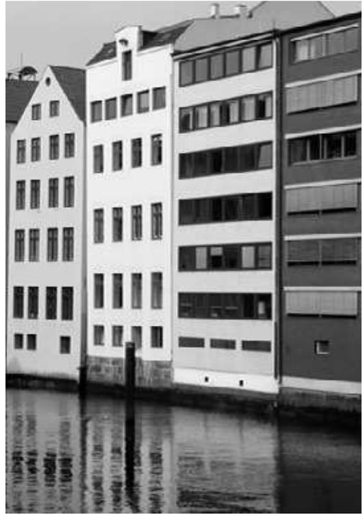
**Bild 13.** Fälle mit Erhöhung der thermischen Belastung durch Reflektion der solaren Strahlung auf Wasseroberflächen
