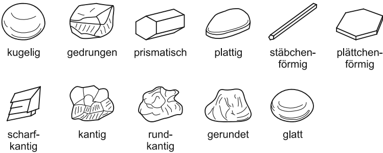
Bild 1-7 Bezeichnungen für Kornform (oben) und Kornrauigkeit (unten) (nach [163], Kapitel 1.3)
