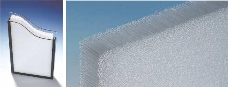
**Bild 1-5** links: Transparente Wärmedämmung im SZR einer Isolierverglasung; rechts: Kapillarplatte aus transparentem PMMA
