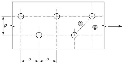
Bild 6.1. Versetzte Löcher und kritische Risslinien 1 und 2
