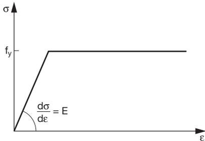
**Bild 5.8.** Bi-lineare Spannungs-Dehnungsbeziehung
