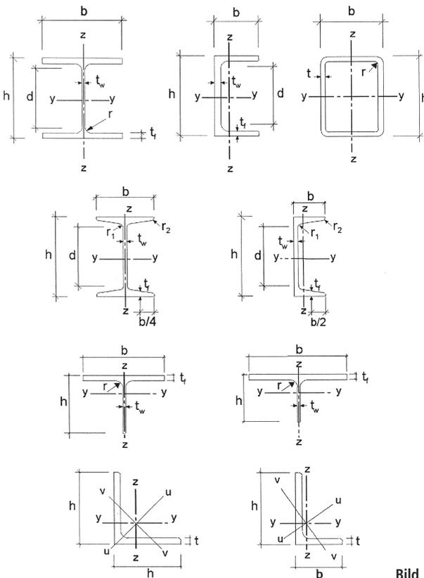
Bild 1.1. Abmessungen und Achsen von Profilquerschnitten
