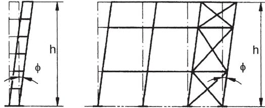
**Bild 5.2.** Äquivalente Stützenschiefstellung
