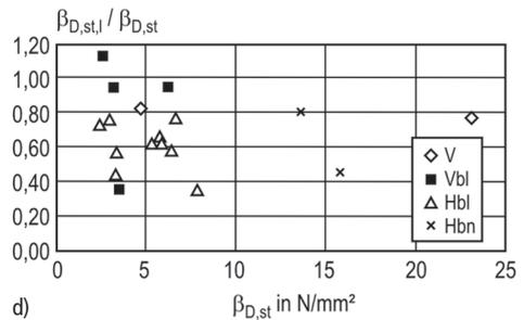
**Bild 1.** Steinlängs- $(\beta_{D,st,l})$  / Normdruckfestigkeit  $(\beta_{D,st})$  in Abhängigkeit von der Normdruckfestigkeit [10]; a) Leichthochlochziegel, b) Kalksandvollsteine, Kalksandlochsteine, c) Porenbeton-Blocksteine, Porenbeton-Plansteine, d) Leichtbetonsteine, Betonsteine
