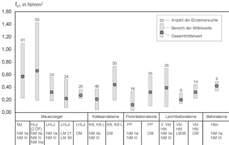
Bild 6. Bandbreite der Biegezugfestigkeitswerte senkrecht zur Lagerfuge, aus [54]
