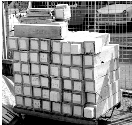
Abb. 1.1 Probekörper mit Styroporkern aus einem der ersten Forschungsprojekte mit Textilbeton (TRC) (Quelle: IMB, TU Dresden [23]).
