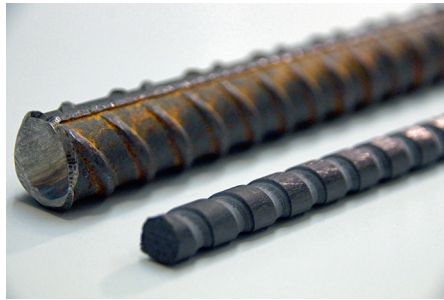
Abb. 1.6 Querschnittsvergleich Stahl- und Carbonbewehrung (Quelle: TU Dresden, Sandra Kranich).
