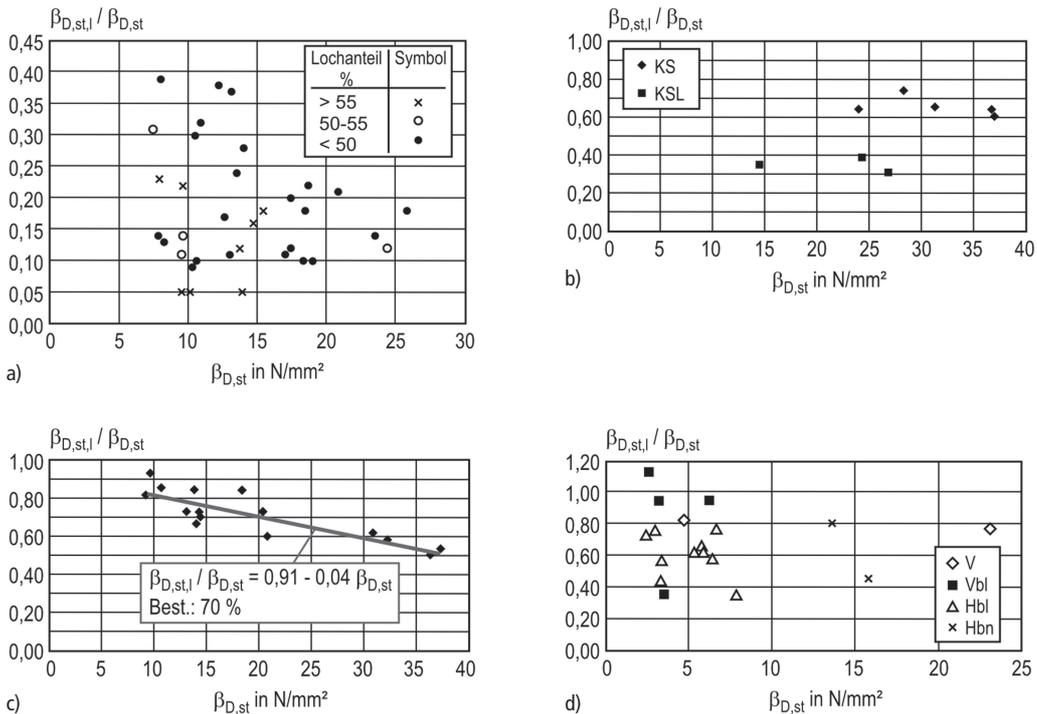
**Bild 1.** Steinlängs- $(\beta_{D,st,l})$ /Normdruckfestigkeit  $(\beta_{D,st})$  in Abhängigkeit von der Normdruckfestigkeit [10]; a) Leichthochlochziegel, b) Kalksandvollsteine, Kalksandlochsteine, c) Porenbeton-Blocksteine, Porenbeton-Plansteine, d) Leichtbetonsteine, Betonsteine
