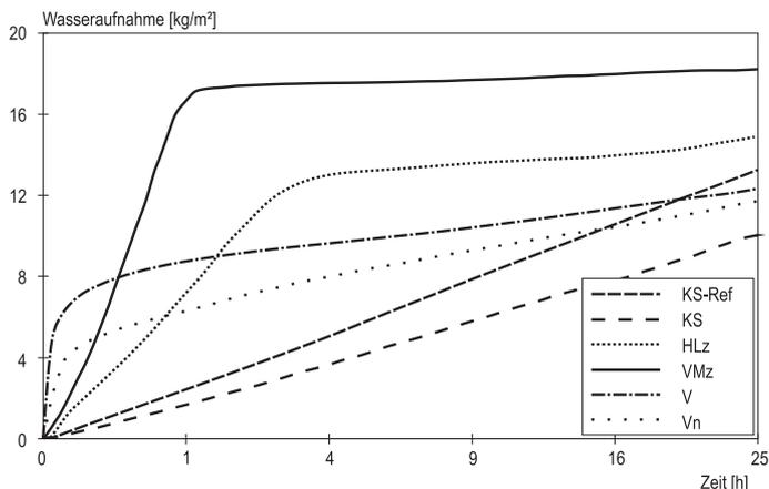
**Bild 1.** Zeitlicher Verlauf der Wasseraufnahme unterschiedlicher Mauersteine, nach [4]
