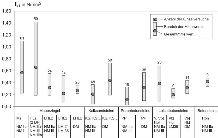
Bild 6. Bandbreite der Biegezugfestigkeitswerte senkrecht zur Lagerfuge (aus [13])
