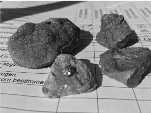
**Bild 3.** Pyritknollen auf einzelnen Bruchstücken des Tunnelausbruchmaterials des Alborlandtunnels
