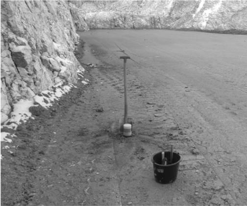
**Bild 9.** Entnahme einer Stechzylinderprobe am Rand des Monokörpers zur Prüfung der Fläche auf ausreichende Verdichtung (6. Februar 2018)
