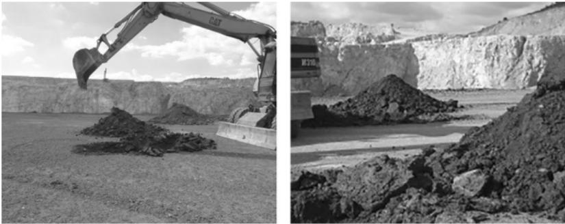
**Bild 14.** Beprobung des bereits eingebauten Tunnelausbruchs
