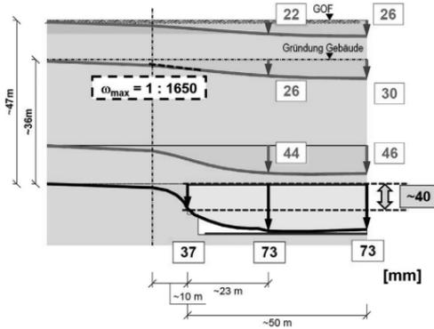
Bild 9. Errechnete Senkungen, Vortrieb 1. Röhre, Längsschnitt
