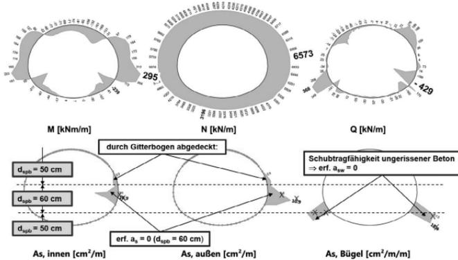
Bild 5. Spritzbetonschale 1. Röhre, Bemessung nach Auffahren 2. Röhre
