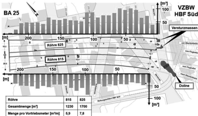
Bild 19. Regelsicherung und Sondermaßnahmen, Verpressmengen
