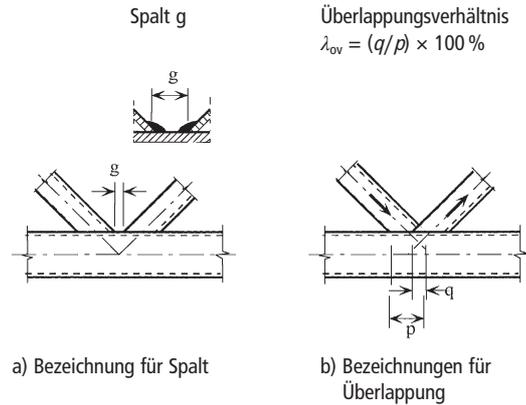
**Bild 1.3.** Knotenanschlüsse mit Spalt und mit Überlappung
