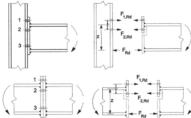
**Bild 6.16.** Vereinfachte Berechnung von geschraubten Anschlüssen mit überstehenden Stirnblechen
