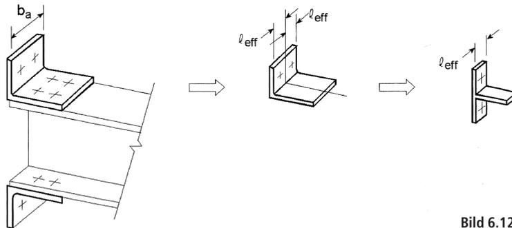
Bild 6.12. Wirksame Länge  $\ell_{\text{eff}}$  von Flanschwinkeln
