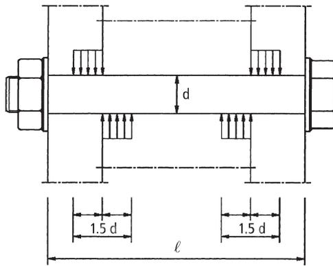
**Bild 3.6.** Begrenzung der effektiven Länge von langen Injektionsschrauben
