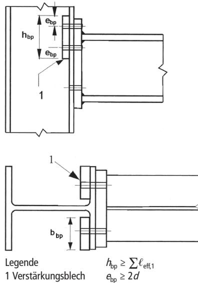
Bild 6.3. Stützenflansch mit Verstärkungsblechen
