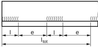
**Bild 4.7.** Berechnung der Scherkräfte auf unterbrochen geschweißte Schweißnähte
