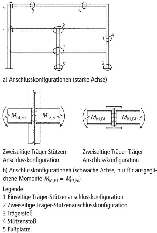
Bild 1.2. Anschlusskonfigurationen
