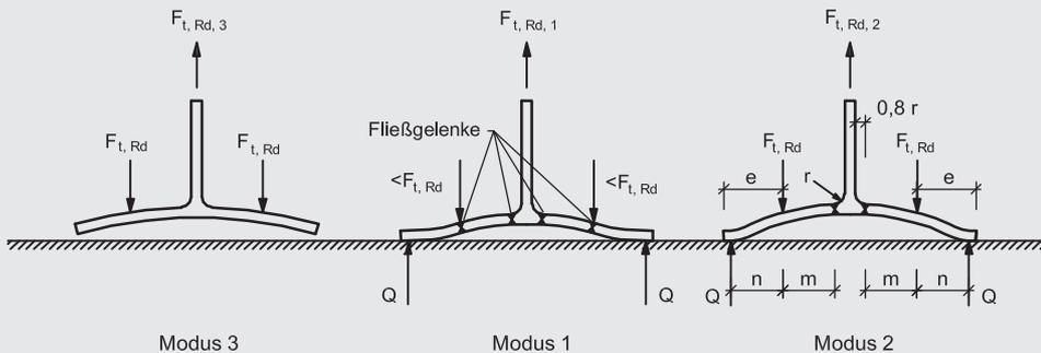
**Bild K8.** Versagensarten des T-Stummels mit zwei Schrauben in einer Reihe
