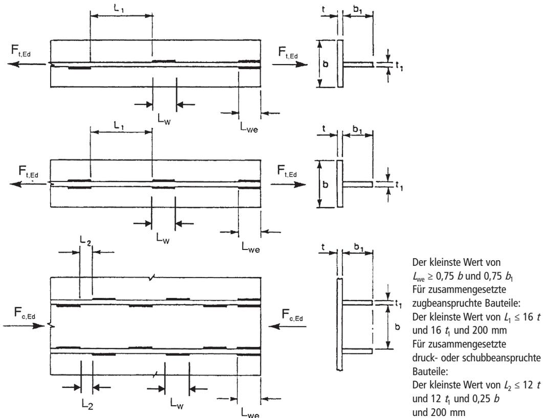
Bild 4.1. Unterbrochen geschweißte Kehlnähte
