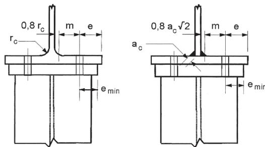
a) Geschweißtes Stirnblech schmäler als der Stützenflansch
