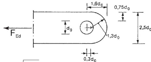
$$t \geq 0,7 \sqrt{\frac{F_{Ed} \gamma_{M0}}{f_y}} \quad ; \quad d_0 \leq 2,5t$$
