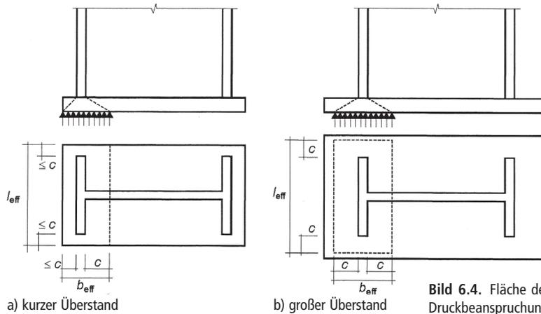
Bild 6.4. Fläche des äquivalenten T-Stummels mit Druckbeanspruchung
