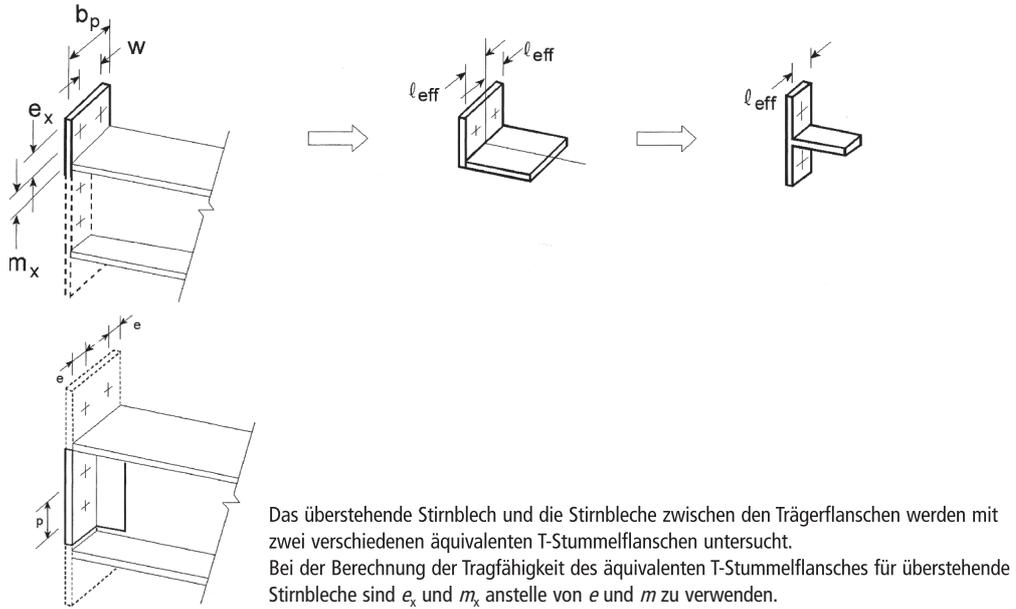
Bild 6.10. Behandlung von überstehenden Stirnblechen als separate T-Stummelflansche
