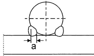
**Bild 4.2.** Wirksame Nahtdicke von Hohlkehlnähten an Vollquerschnitten
