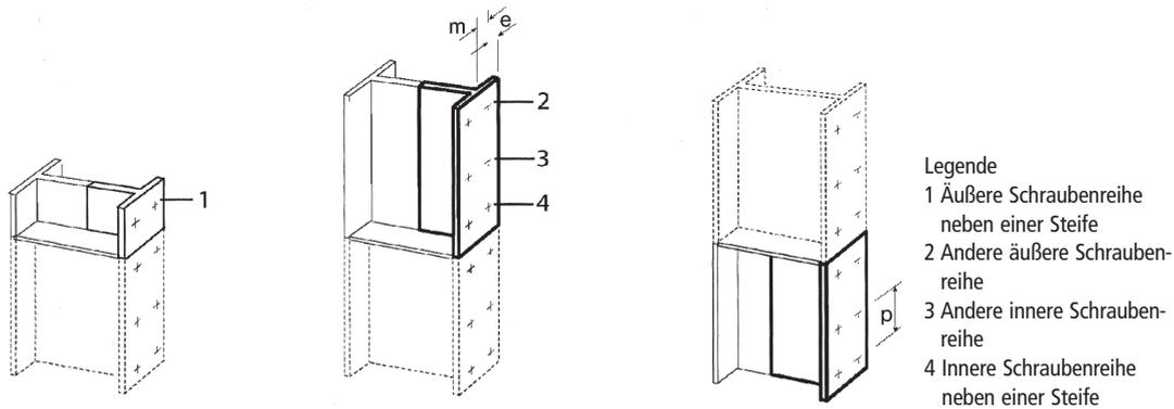
Bild 6.9. Untersuchung eines ausgesteiften Stützenflansches mit verschiedenen T-Stummel-Modellen
