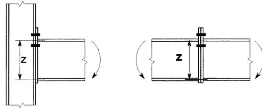
Bild 6.20. Hebelarm  $z$  für das vereinfachte Verfahren
