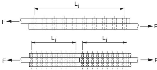
Bild 3.7. Lange Anschlüsse
