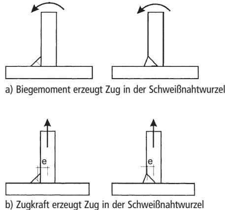
**Bild 4.9.** Einseitige Kehlnähte und einseitige nicht durchgeschweißte Stumpfnähte
