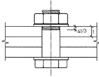
**Bild 3.2.** In ein Schraubenloch hineinragendes Gewinde von Passschrauben
