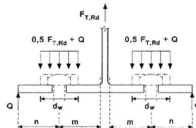
Anmerkung 1: Bei geschraubten Träger-Stützenanschlüssen oder Trägerstößen kann damit gerechnet werden, dass Abstützkräfte auftreten.
