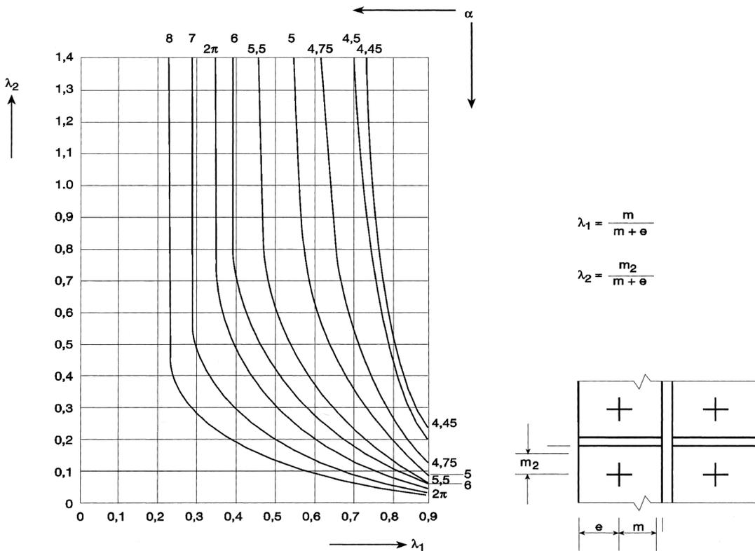
Bild 6.11.  $\alpha$ -Werte für ausgesteifte Stützenflansche und Stirnbleche
