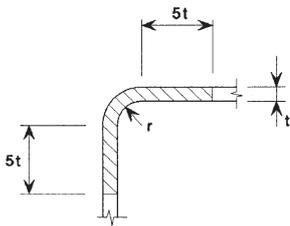
Anmerkung: Bei kaltgeformten Hohlprofilen nach EN 10219, die nicht die in Tabelle 4.2 festgelegten Grenzen erfüllen, kann vorausgesetzt werden, dass sie diese Grenzen erfüllen, sofern diese Profile eine Dicke aufweisen, die nicht größer als 12,5 mm und Al-beruhigt sind mit einer Qualität von J2H, K2H, MH, MLH, NH oder NLH und ferner  $C \leq 0,18\%$ ,  $P \leq 0,020\%$  und  $S \leq 0,012\%$  erfüllen.
