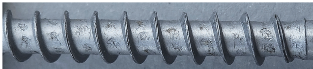
Abb. 1.4 Gewinde einer kaltumgeformten Holzschraube mit Oberflächenfehlern [4].
