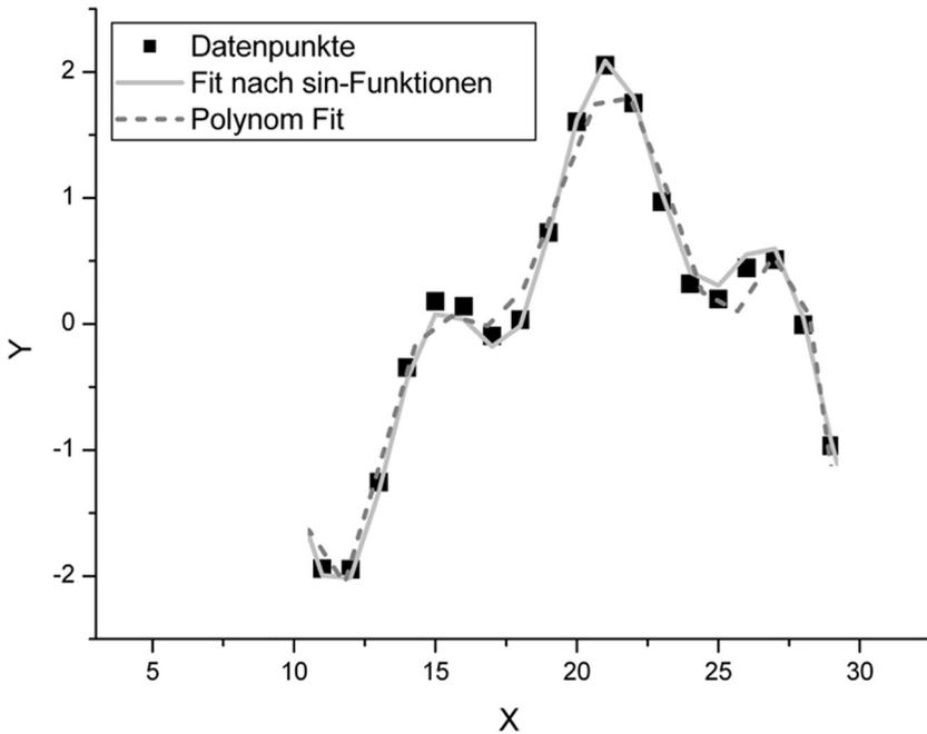
**Abb. 1.1** Anfitzen einer Messkurve. Die durch schwarze Vierecke symbolisierten, experimentell erhaltenen Messwerten können u. a. durch zwei verschiedene Gleichungen gut beschrieben werden. Eine davon, hier als durchgehend graue Linie dargestellt, ist aus diversen Sinus-Termen zusammengesetzt, während die durchbrochene graue Linie ein Polynom dar-
