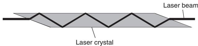
Fig. 1.13 Slab laser.
