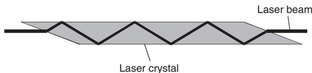
Fig. 1.13 Slab laser.
