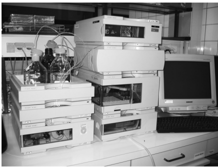
Abb. 1.4 Hochdruck-Flüssigkeitschromatographie: schematisch (rechts), Anlage im Labor (links).
