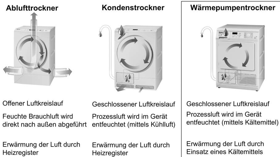
Abb. 1.27 Funktionaler Aufbau von Wäschetrocknern (Quelle: Miele).
