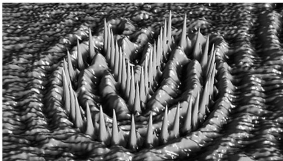
**Abbildung 1.7:** Mit einem Rastertunnelmikroskop können einzelne Atome auch in der Form von Buchstaben arrangiert werden. Hier dargestellt ist ein Firmensymbol bestehend aus 42 Silberatomen auf einer Silberoberfläche. © Omicron NanoTechnology GmbH, Taunusstein
