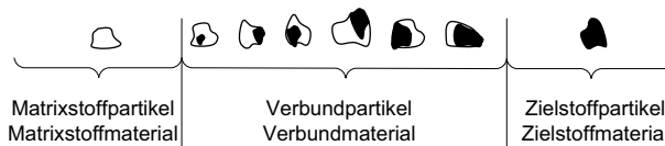
Abbildung 1.3 Partikelarten und korrespondierende Schüttgüter.
