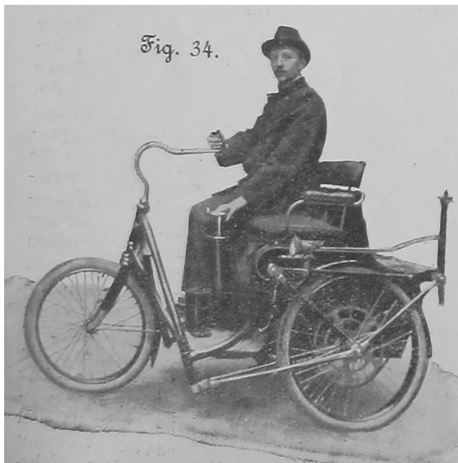
Abb. 1.1 Batteriebetriebenes Fahrzeug Electra (Krüger, Berlin, 1899).
