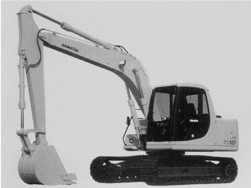
Abb. 1.1 Hydraulischer Raupenkettensbagger. (Foto mit freundlicher Genehmigung der Komatsu Ltd.)
