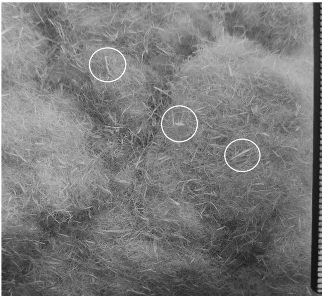
**Abb. 1.30** Fasern aus Refiner-Aufschluss, makroskopische Ansicht. Fichtenholzfasern und -bündel (Shives), Aufschluss im Labor-Refiner, Bildfeld ca.  $50 \times 50 \text{ mm}^2$ , drei der sichtbaren Shives (vgl. Abb. 1.3 in Abschn. 1.1) sind exemplarisch markiert.
