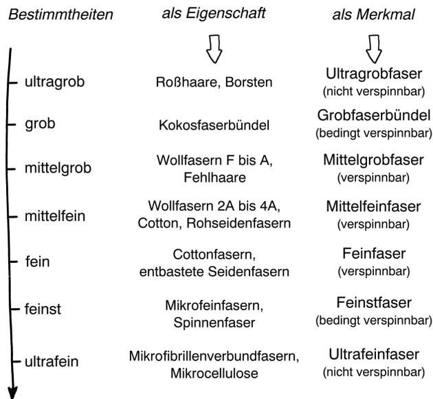
Abb. 1.20 Systematik der Faserfeinheiten (Übersicht entwickelt auf der Basis der Systematik der Textilien [3]).
