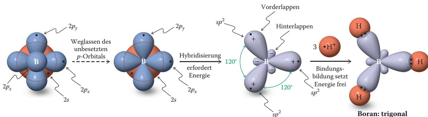
**Abb. 1.17** Die Hybridisierung im Boratom liefert drei  $sp^2$ -Hybridorbitale. Das  $1s$ -Orbital und der Knoten in den  $2s$ -Orbitalen sind nicht gezeigt. Ab der vollständigen Darstellung der relevanten Orbitale um das Boratom (links) wurde das unbesetzte  $p$ -Orbital der Übersicht halber weggelassen. Die resultierende Bindung verleiht  $\text{BH}_3$  trigonal-planare Struktur. Das Vorzeichen der drei Vorderlappen ist entgegengesetzt zu
