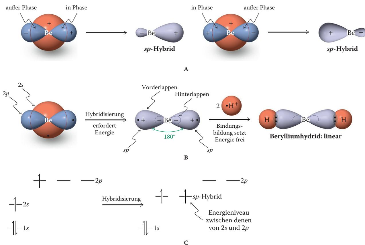
**Abb. 1.16** (A) Hybridisierung von Beryllium zu zwei  $sp$ -Hybridorbitalen. (B) Die resultierende Bindung verleiht  $\text{BeH}_2$  lineare Struktur. Die beiden übrigen  $p$ -Orbitale und das  $1s$ -Orbital wurden der Übersicht halber weggelassen. Die großen  $sp$ -Lappen und die kleinen Lappen haben umgekehrte Vorzeichen der Wellenfunktion. (C) Energieände-
