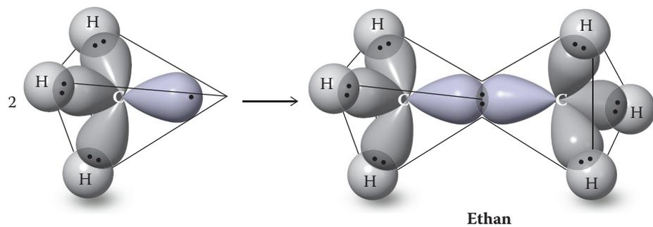
**Abb. 1.19** Ausbildung der Kohlenstoff-Kohlenstoff-Bindung im Ethan durch Überlagerung zweier  $sp^3$ -Orbitale.
