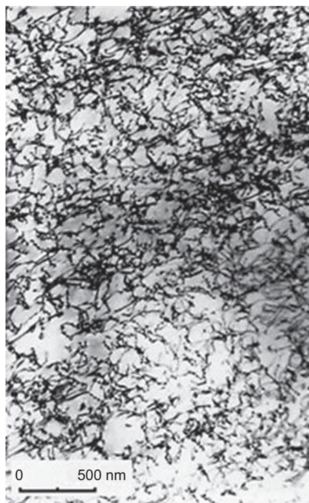
Abb. 1.33 Versetzungsanordnung in einer schwach verformten Legierung CoCr22Ni22W14 [3] R. Wünsch, U. Mühle, U. Martin, W. Pantleon, H. Oettel (Chapter Author); Z. Metallkunde 88(1997)10, 790
