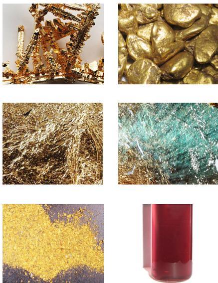
**Abbildung 1.6-13.** Verschiedene Formen von Gold (Goldkristalle, Goldnugget, Blattgold in Auf- und Durchsicht, Goldpulver, kolloidales Gold).
