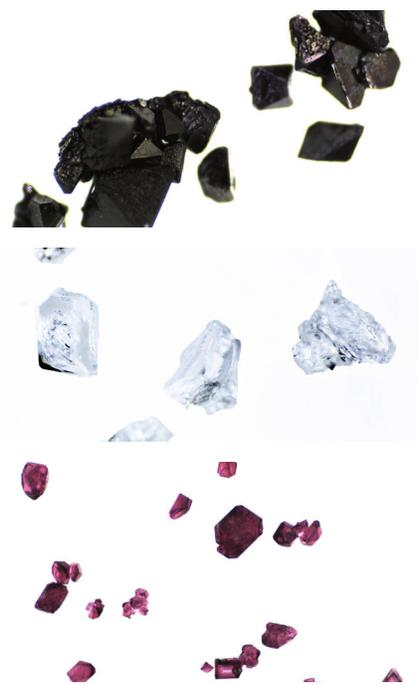
**Abbildung 1.8-5.** Kaliumpermanganat (violett), Kaliumperchlorat (farblos) und ein Mischkristall aus beiden Stoffen (rot).
