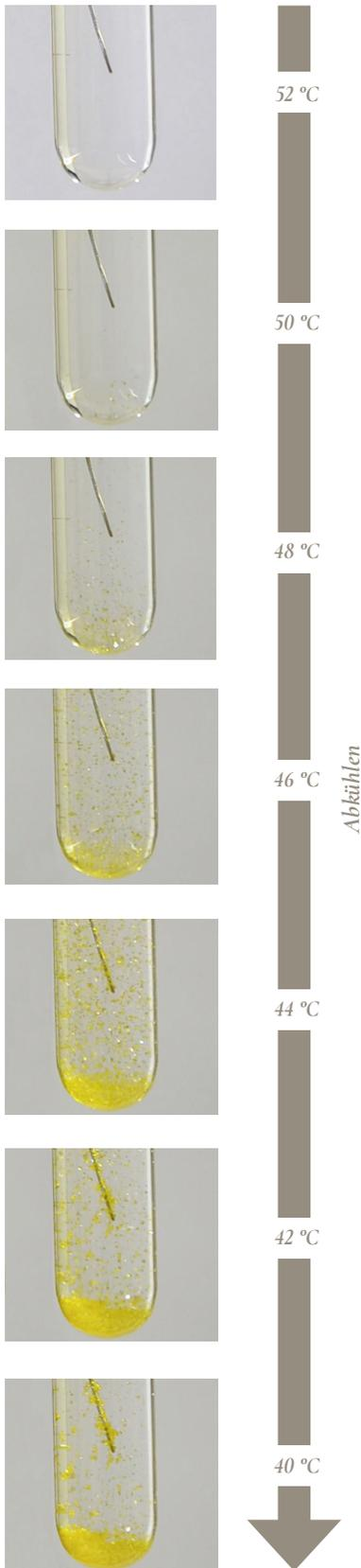
Abbildung 1.4-23. Gesättigte Lösung von Bleiiodid. Beim Abkühlen von 52 °C bis 40 °C bildet sich ein Bodenkörper.
