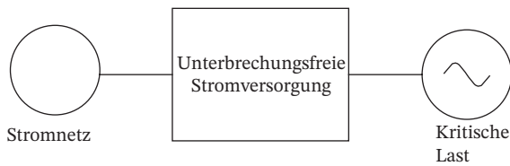
Abb. 1.13 Unterbrechungsfreie Stromversorgung (USV).
