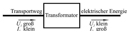
**Bild 1.1.2** Zur Aufgabe des Transformators als Verbindungselement zweier Spannungsebenen eines Transportwegs elektrischer Energie
