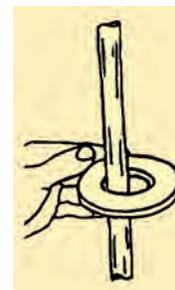
**Abb. 1** Die Scheibe wird mit der Hand in Gang gesetzt und läuft auf einer Spiralbahn am Stab hinab.
