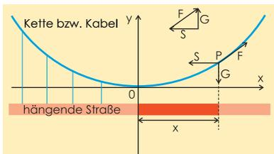
**Abb. 11 Bei einer Hängebrücke ergibt sich als Kurvenform für das Tragekabel eine Parabel.**
