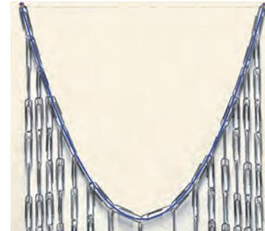
**Abb. 7** Parabel mit 16 Büroklammern und Gewichten. Aus Übersichtsgründen sind die langen Ketten der hängenden Büroklammern nicht ganz abgebildet. Eine ideale Parabel (blau) wurde grafisch darüber gelegt.
