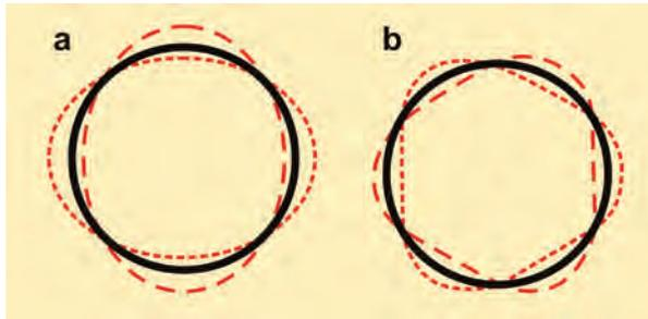
**Abb. 2** Schwingungsmoden des Glases (stark übertrieben gezeichnet. a) Grundschwingung, b) Oberschwingung
