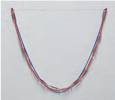
**Abb. 5** Kettenlinie mit 16 Büroklammern. Die Büroklammern sind hinter der idealen Kettenlinie (rot) und Parabel (blau) noch zu erkennen.
