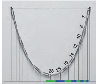
**Abb. 6** Konstruktion einer Hängebrücke. Die Zahlen stellen den in Millimeter gemessenen Abstand der Tragekabel dar.
