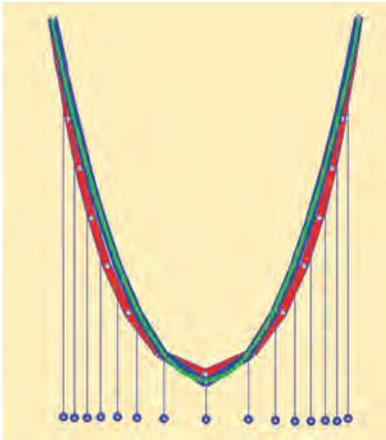
**Abb. 8 Simulation von Kettenlinie und Parabel mit Interactive Physics.**
