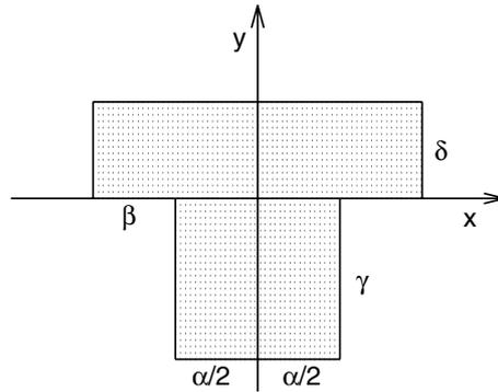
Abb. 1.7. Querschnitt eines T-Trägers
