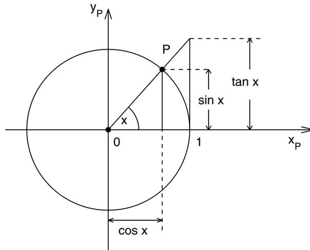
**Abb. 1.13.** Trigonometrische Funktionen am Einheitskreis
