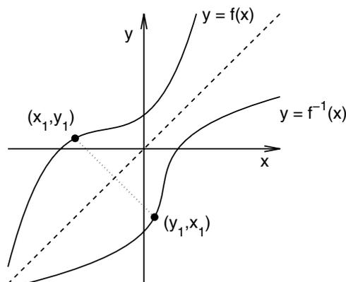
Abb. 1.9. Konstruktion der Umkehrfunktion
