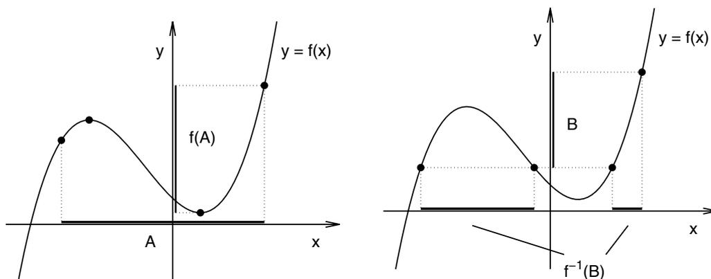
Abb. 1.8. Bild und Urbild einer Funktion  $y = f(x)$
