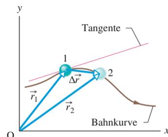
Abb. 1.9 Die Verschiebung  $\Delta\vec{r}$  eines Teilchens während eines Zeitintervalls  $\Delta t$  von Position 1 mit Ortsvektor  $\vec{r}_1$  zur Zeit  $t_1$  zur Position 2 mit Ortsvektor  $\vec{r}_2$  zur Zeit  $t_2$ . Eingezeichnet ist auch die Tangente an die Bahnkurve des Teilchens am Ort 1.
