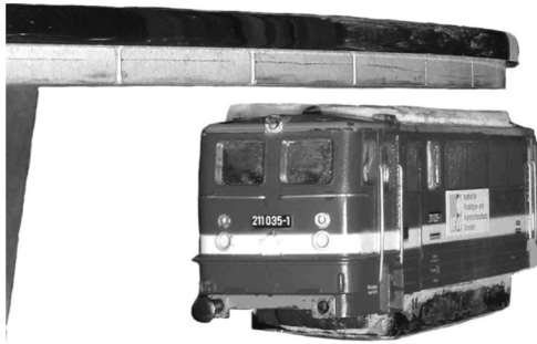
Abb. 1.11 Hängender Spielzeugschwebzug am Leibniz Institut für Festkörper- und Werkstoffforschung, Dresden [20] (Abbildung mit Erlaubnis von deGruyter).
