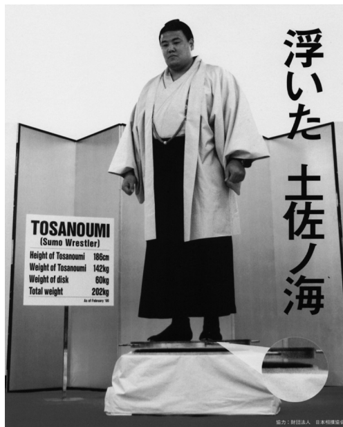
Abb. 1.6 Anwendung der berührungsfreien Levitation durch die Dauerströme in Supraleitern. Der Sumoringer inklusive Bodenplatte wiegt 202 kg. Der verwendete Supraleiter ist \text{YBa}_2\text{Cu}_3\text{O}_7 (Wiedergabe mit freundlicher Genehmigung durch das International Superconductivity Research Center (ISTEC) und Nihon-SUMO Kyokai (Japan, 1997)).
