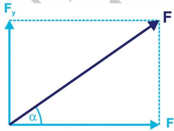
Abbildung 4.5: Zerlegung einer Kraft in zwei zueinander senkrechte Komponenten
