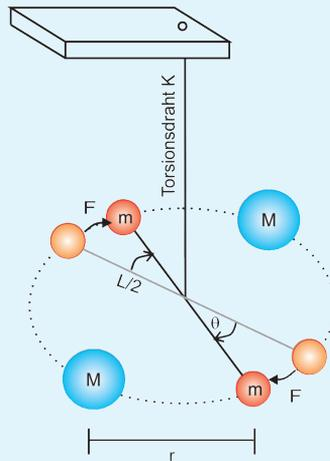
Abbildung 4.9: Eine Gravitationswaage
