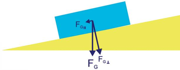
Abbildung 4.6: Zerlegung einer Gewichtskraft
