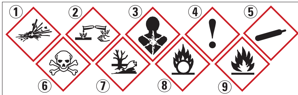
Abbildung 1.5: Gefahrstoffsymbole: 1: »explosiv«, 2: »reizend/ätzend«, 3: »gesichert CMR-sensibilisierend«, 4: »möglicherweise CMR-sensibilisierend«, 5: »komprimierte Gase«, 6: »giftig/sehr giftig«, 7: »umweltgefährlich«, 8: »oxidierend/brandfördernd« und 9: »entzündlich«
