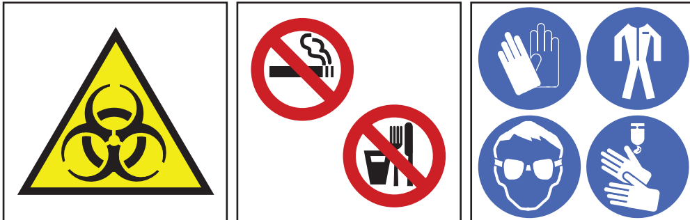
Abbildung 1.4: Hinweisschilder im Labor. Links: Warnschild »Biologische Gefahr«. Mitte: Verbotsschilder »Rauchen verboten« und »Essen und Trinken verboten«. Rechts: Gebotsschilder »Schutzhandschuhe«, »Schutzkittel«, »Schutzbrille« und »Händedesinfektion«
