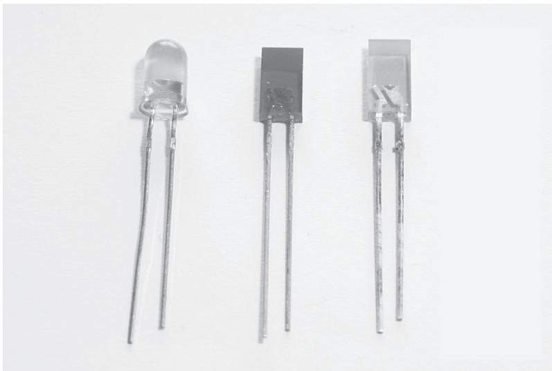
**Abbildung 1.7:** Leuchtdioden in verschiedenen Farben und Formen
